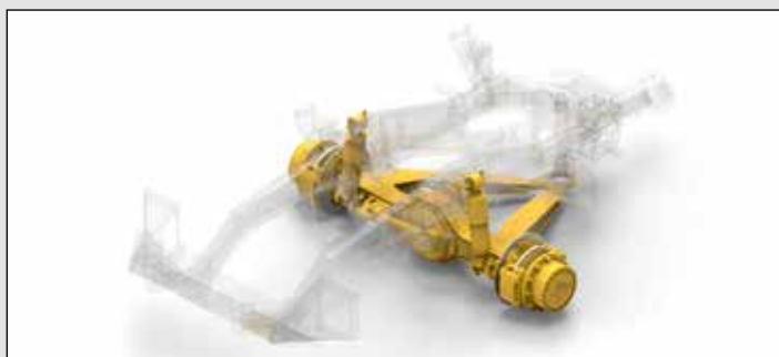
Pour assurer une productivité confortable, le système de suspension avant, constitué d'une structure en "A" supportée par des vérins huile-azote, réduit les vibrations latérales souvent constatées en utilisation tous-terrains. Un siège doté d'une suspension supérieure procure une isolation améliorée de l'opérateur.
