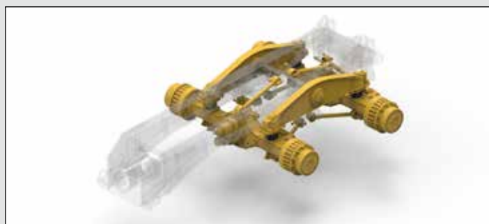
De mauvais terrains réclament de solides suspensions. Des composants à haute résistance absorbent les chocs encore et encore. Vous obtenez également le meilleur débattement de suspension ainsi que la meilleure garde au sol.
